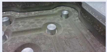
Abschließende 3D-Bearbeitungssimulation & Fertigung der Lasertextur in 5 Achsen
